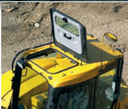
Aufklappbare Dachluke für optimale Sicht nach oben
